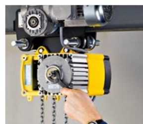
Удобный доступ к фрикционной муфте для регулировки
