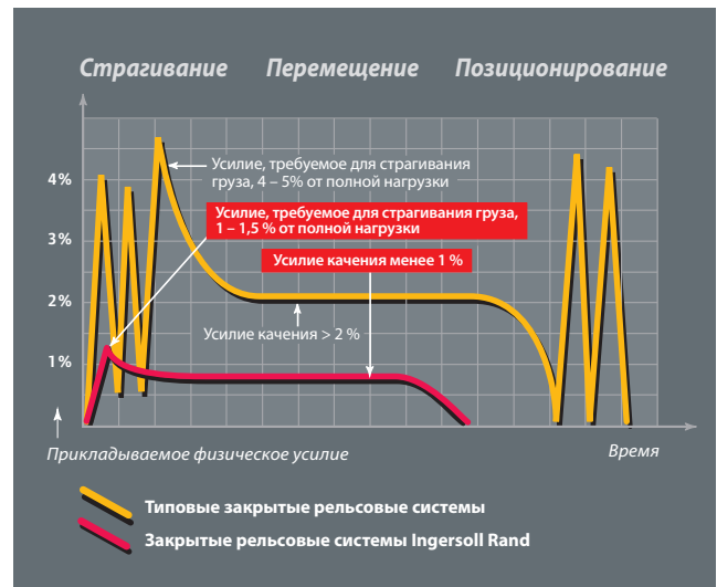
Толкающее усилие по центру мостового рельса. Усилие качения менее 0,5 кг для груза 100 кг
