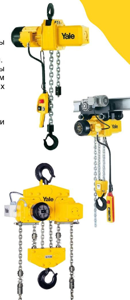
Модель CPE 100-2 состоит из двух талей CPE 50-2, связанных единой балкой для подвески тали. В стандартной комплектации они имеют низковольтное 42В управление, выключатели верхнего и нижнего положения крюка.
